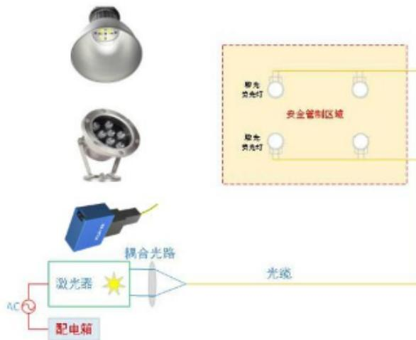
光电分离照明光源系统是其它照明设计不易达成的效果。另外在油库、矿区、化工厂等严禁火种入内的危险场合中，其它的照明设备都有明火的危险，光电分离照明光源系统适合解决这类易燃易爆等防爆问题，而且在医疗或是特殊实验的环境里，有电磁屏蔽等问题的特殊场所，也是光电分离照明光源系统的强项和优势所在。此类型的光电分离照明光源产生的光源可以帮助客户实现电子设备远离高危场所，通过光纤传输光源到安全管制区域，实现远距离光电分离照明，彻底杜绝起火触电等各类安全隐患，该光电分离照明光源可接受非标定制。
